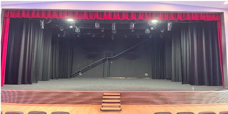
El aforamiento del escenario es mediante telón de boca en formato “americano” motorizado, bambalinón, 4 bambalinas, 8 patas (cuatro por lado) y telón de fondo también en formato “americano” y cierre manual.
